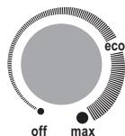
➤ Um die Kühlleistung zu **erhöhen**, drehen Sie den Kühlleistungsregler im Uhrzeigersinn.
